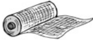
Media sombra de 80 % de cobertura. 0,75 m 2 por cada metro de zanja.
